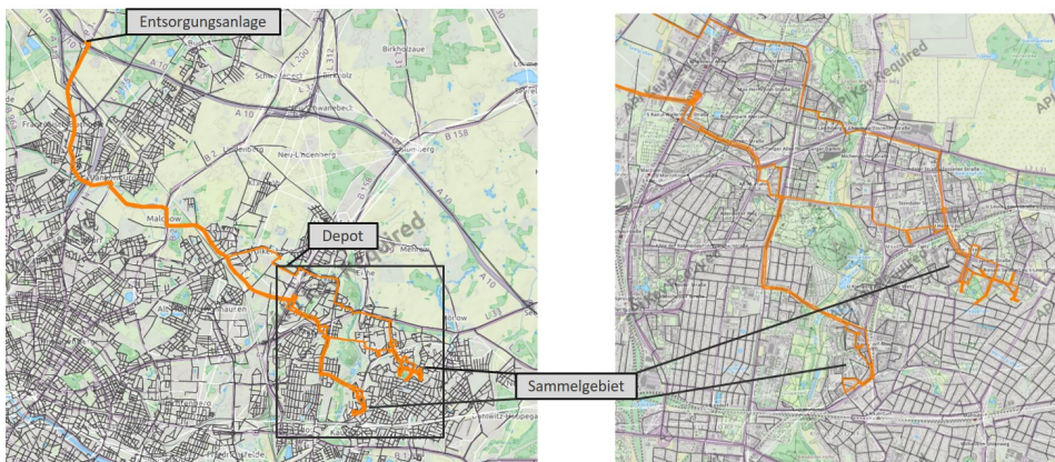
Abbildung 4: Eine synthetisch erzeugte Trajektorie eines Fahrzeugs. Kartenmaterial von Open Street Maps [16] mit eigenen Ergänzungen unter Nutzung eigener Daten sowie der Software VIA
