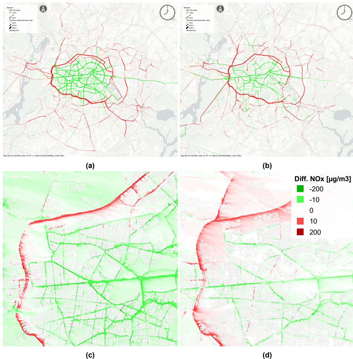
Abbildung 8: Oben: Differenz der Verkehrsbelastung um 8 (links) und um 20 Uhr (rechts) für Szenario 3. Unten: Differenzen der Schadstoffkonzentrationen um 8 (links) und um 20 Uhr (rechts) für Szenario 3
